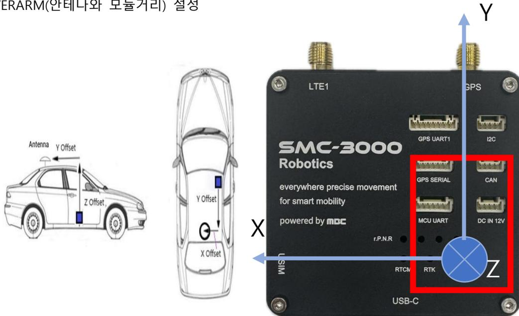
GNSS 안테나 기준으로 단말기의 칩의 거리 측정 (Offset의 경우 진행방향(화살표 방향)이 + 값임)
